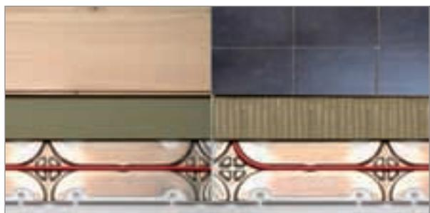
8. Connectez le câble chauffant et la sonde au thermostat, et connectez le thermostat au secteur. Pour terminer, une fois toutes vos plaques DEVicell Rénosol installées, et vos câbles mis en place, couvrez avec une sous-couche de protection acoustique et installez votre revêtement par-dessus. *En version carrelage, la sous-couche n'est pas nécessaire, utilisez un mortier-colle C2S adapté à une surface en aluminium puis collez votre carrelage.*
